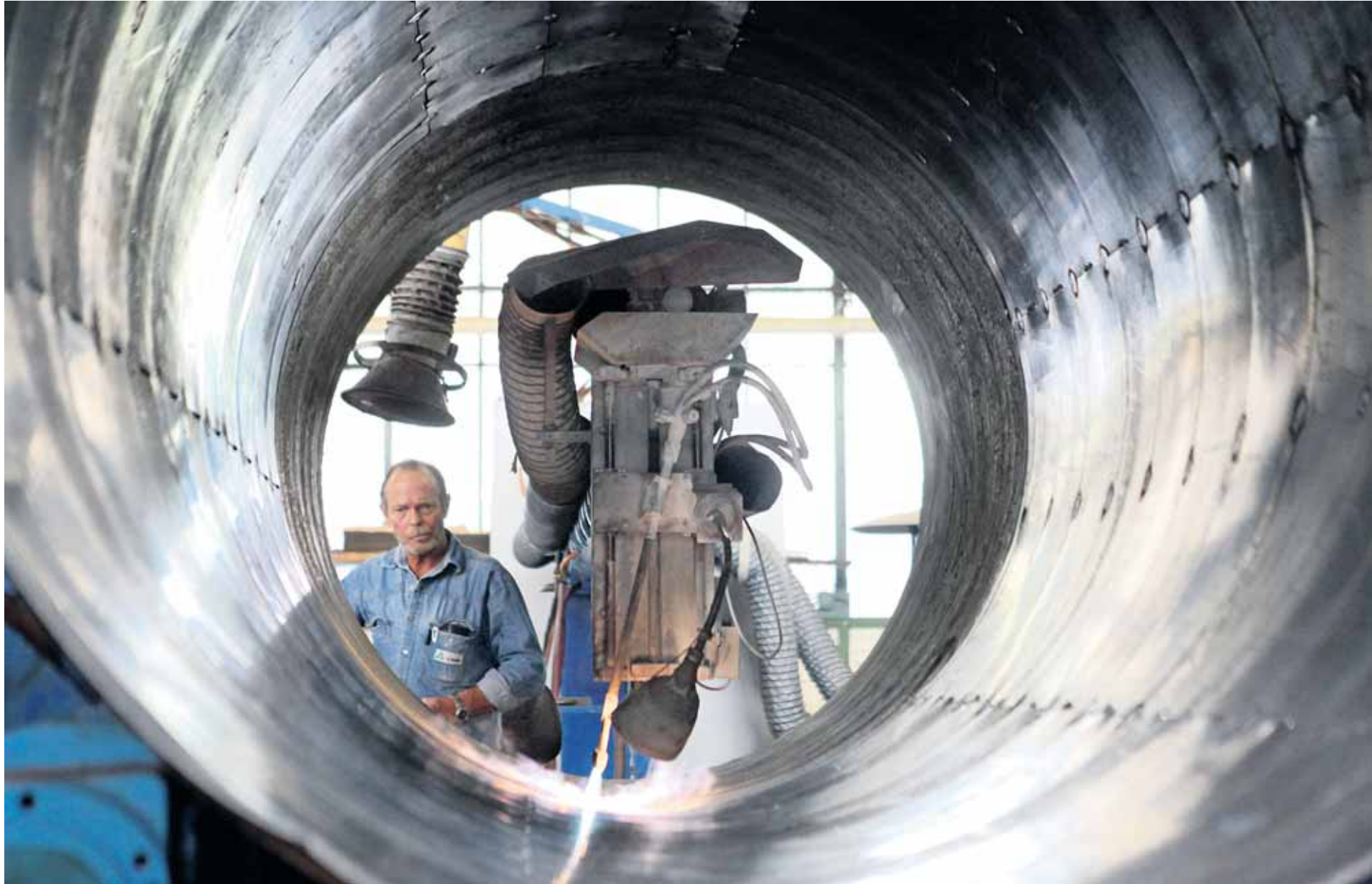
Die Bleischicht in dem Behälter für Brom ist sechs Millimeter stark und wird maschinell aufgebracht. Rund vier bis sechs Stunden dauert der Vorgang, der ständig überwacht wird. Fotos: Kusian-Müller
